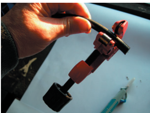
foto 3: ontmantelen met een buizensnijdertje
