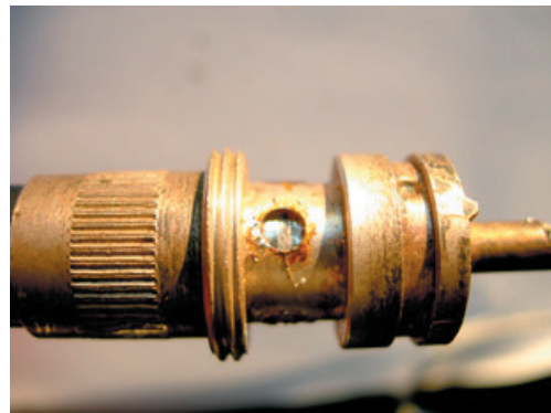
foto 10: de mantel is zichtbaar
